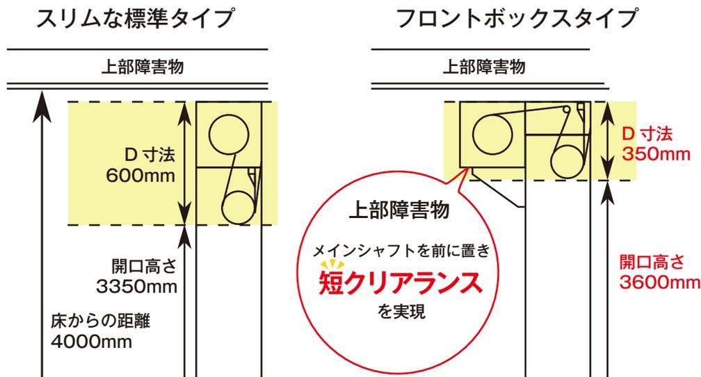
※開口幅 OW6500mm の場合での比較
